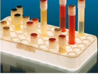
Portoir autobloquant pour 5 rangées de 10 tubes. En polycarbonate blanc. L  $\times$  I  $\times$  h : 192  $\times$  102  $\times$  28 mm.
